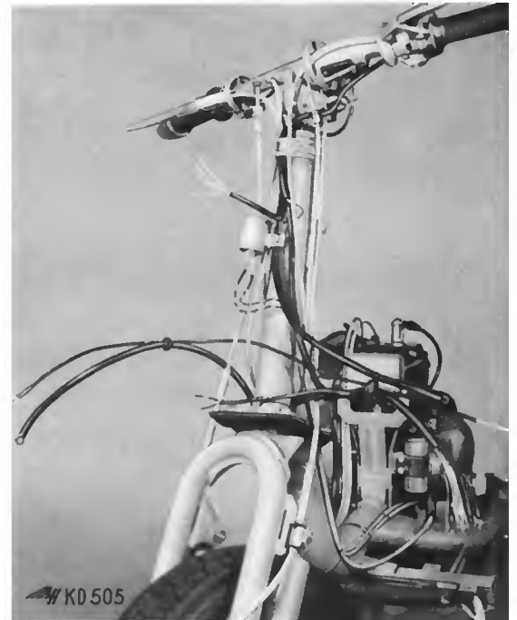
89 Leitungen und Bowdenzüge verlegen
